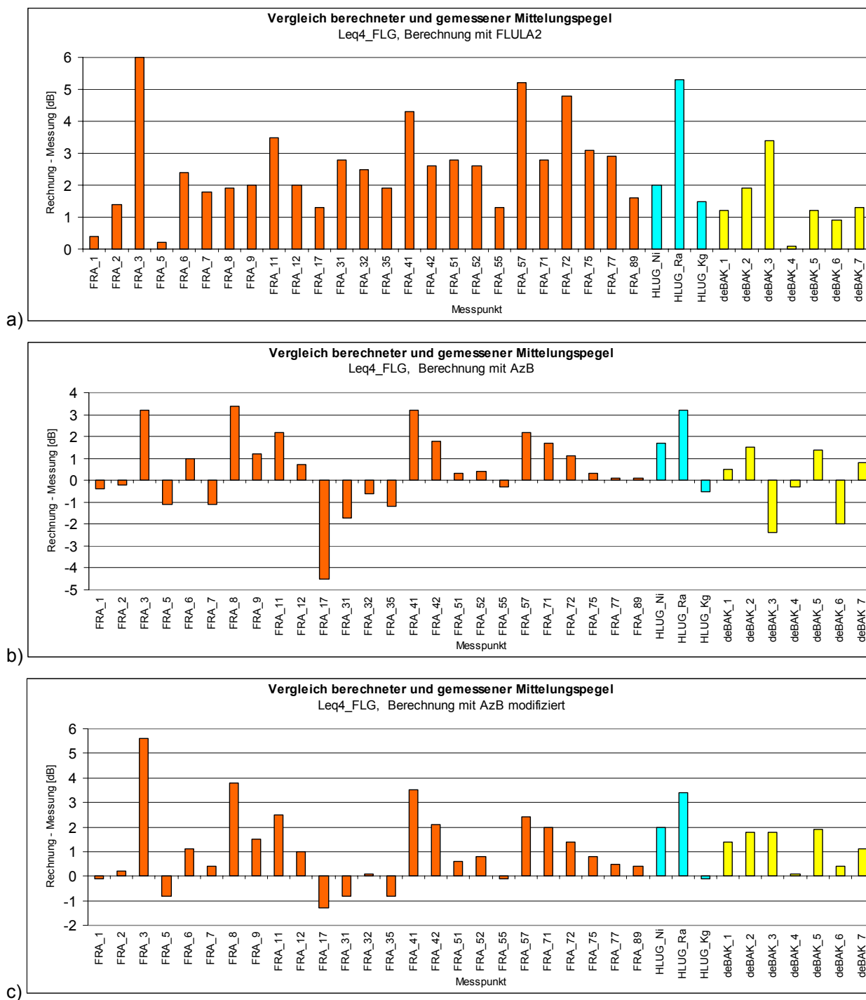
Abbildung 6-1 Differenzen zwischen den mit verschiedenen Berechnungsverfahren berechneten und den gemessenen Mittelungspegeln Leq(4)_{FLG} an verschiedenen Messstationen. Berechnung mit FLULA2 (a), Berechnung nach AzB/99 (b), Berechnung mit modifizierter AzB (c).
